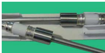
冷却水、LN 2 导入端子
