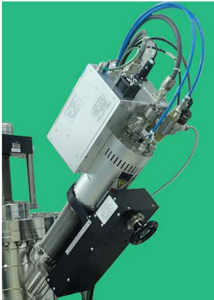
ラジカル源及びZ軸駆動器
